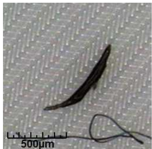
Zweitgrößter nichtmetallischer Partikel 794 µm x 117 µm
