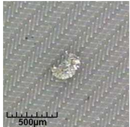
Zweitgrößter metallischer Partikel 325 µm x 218 µm
