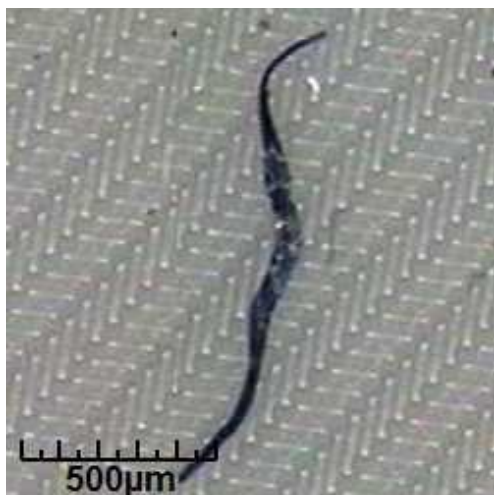
Größter nichtmetallischer Partikel 1219 µm x 75 µm
